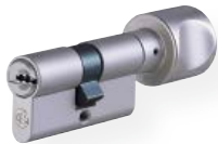
Profil-Knaufzylinder Nr. 815 WSM Messing matt vernickelt eine Seite Schließfunktion, andere Seite Alu-Knauf, F1, diverse Knaufformen erhältlich (abgebildet Form H)
